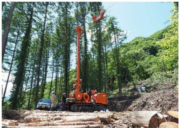
ワイヤーロープを張って集材ができる移動式集材機で作業道がない急な斜面で活躍。
