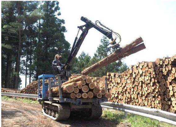
林内に集積された木材を荷台のクレーンで積み込んで土場まで運ぶ集積・運搬機械。
