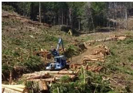
伐採により散在している木材を集積し所定の寸法にそろえ、フォワーダ（運搬車）で土場（丸太をトラックに積む場所）まで運びます。
