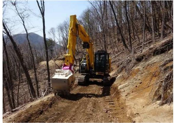
先端のバケットに付いているハサミで木を切断し、回転するバケットで作業道作りに活躍。
