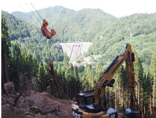
タワーヤードによる全木集材作業
